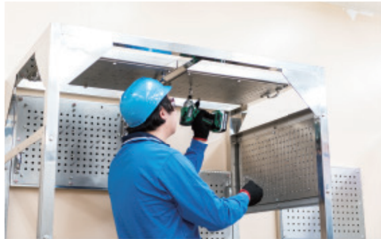
インパクトドライバーを用いたボルトの締め付け研修
