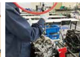
インパクトドライバーを用いたボルトの締め付け研修
